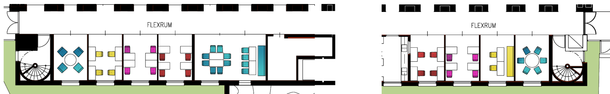
Uppglasade grupprum, gör det mer användarvänligt, dels lättare att se om rummet är ledigt eller upptaget och dels ger det mer ljus ut i korridoren. Olika slags möbler för olika slags studier och antal personer
